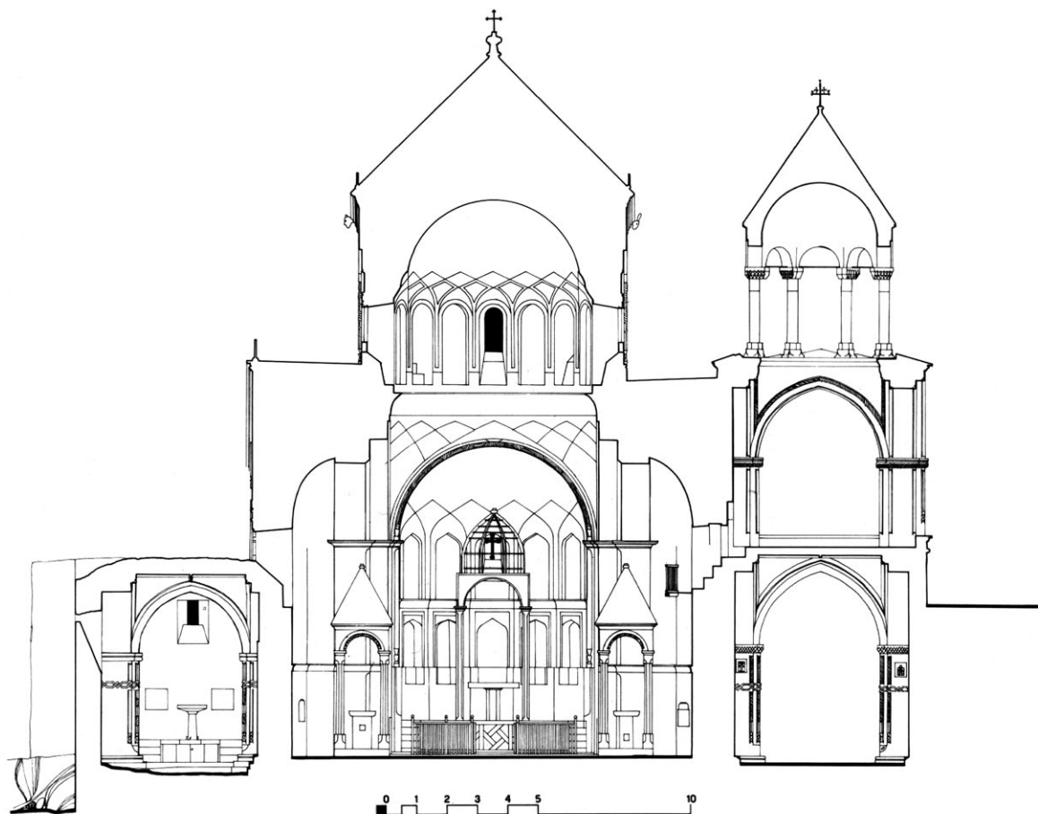
Մաղարդավանքի Սբ. Ստեփանոս եկեղեցու կտրվածքը դեպի հարավ և արևելք (չափ.՝ ճարտ. դր. Հարթմուտ Հոֆրիխտերի)
